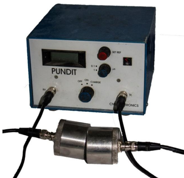
7.6 ábra: Ultrahangos mérőműszer
