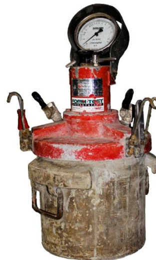
8.10 ábra: Légtartalom vizsgáló készülék
