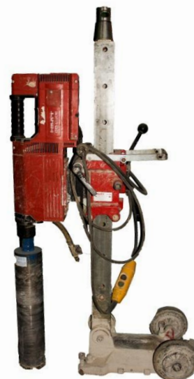
7.1 ábra: Mintavételező fúróberendezés
