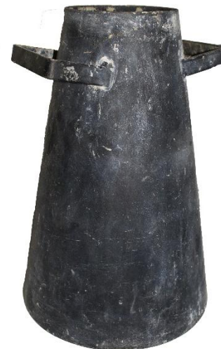
8.5 ábra: Abrams-féle roskadásmérő csanakakúp
