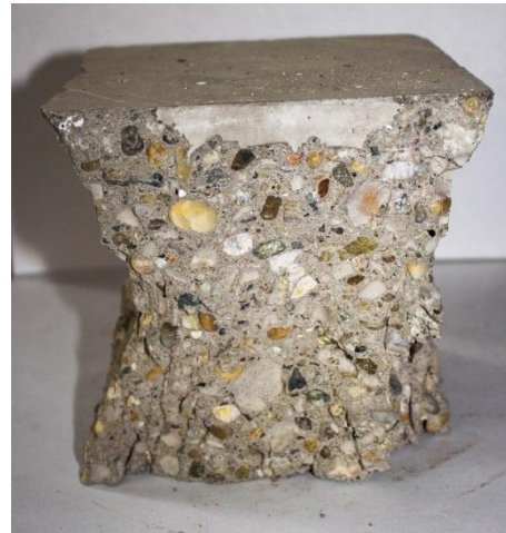
8.14 ábra: Próbakocka törésképe
